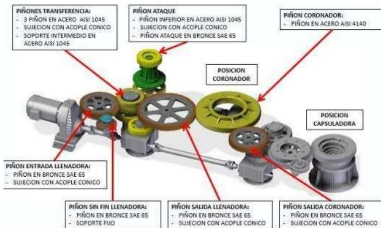
Figura 6 Transmisión llenadora, Maquinados & Montajes S.A.S
