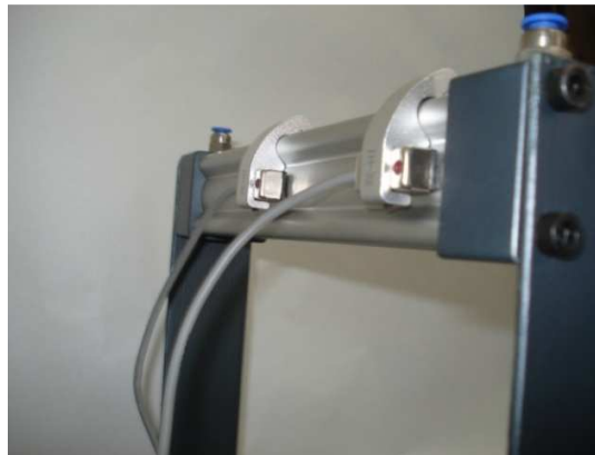
Figura 48. Cilindro dosificador con S5 y S6 [26].
