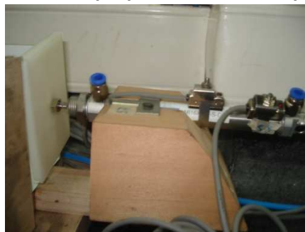
Figura 43. Cilindro (C4) con sensores (S7, S8) [26].
