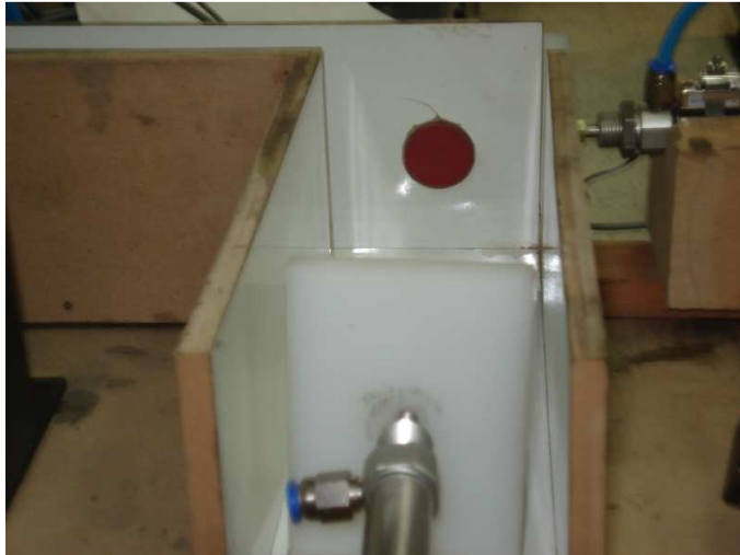
Figura 39. Cilindro con acople y sensor magnético [26].
