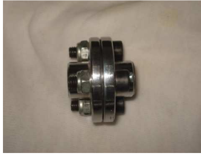
Figura 47. Acople entre cilindro y pistón dosificador [26].
