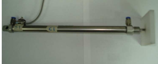
Figura 40. Cilindro (C1) con el sensor magnético (S1) [26].
