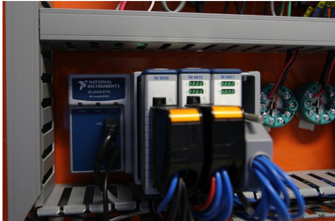
Figura 23. Sistema de Adquisición de Datos Usado en el Módulo de Flujo.
