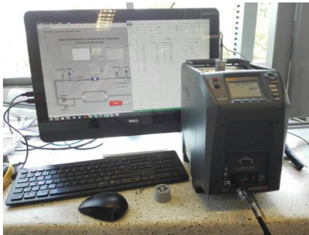
Figura 62. Toma de datos utilizando baño seco
