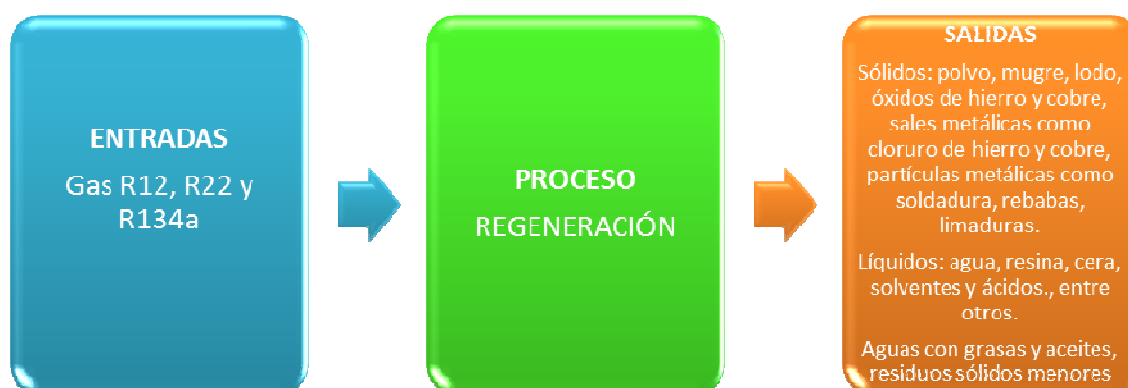
Figura 22. Flujo de materiales en el proceso de regeneración
