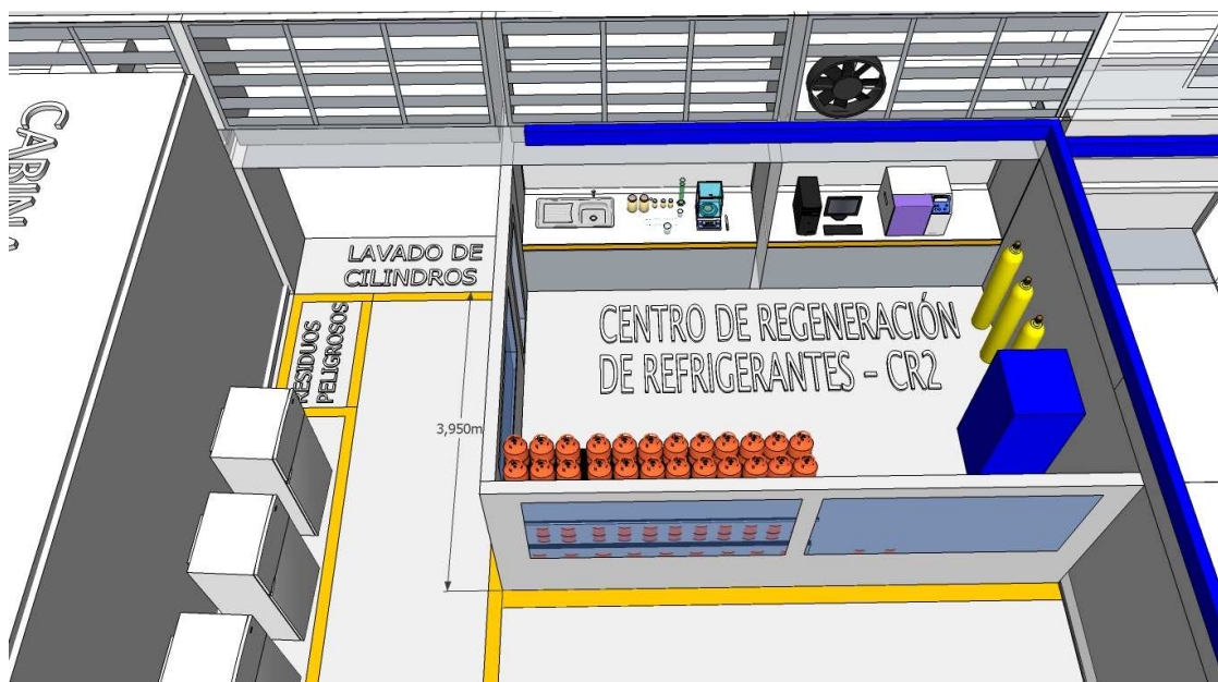
Figura 20. Vista superior del centro de regeneración
