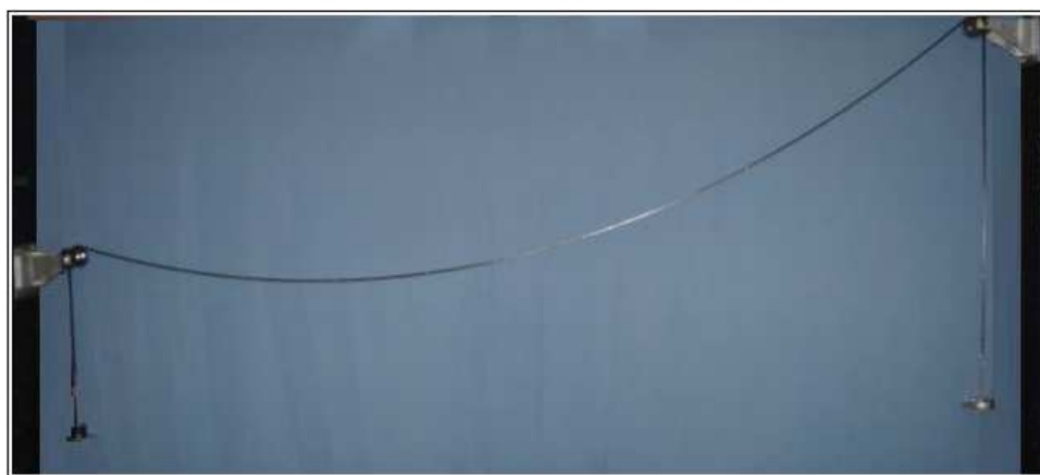
6. Sistema de un cable asimétrico
