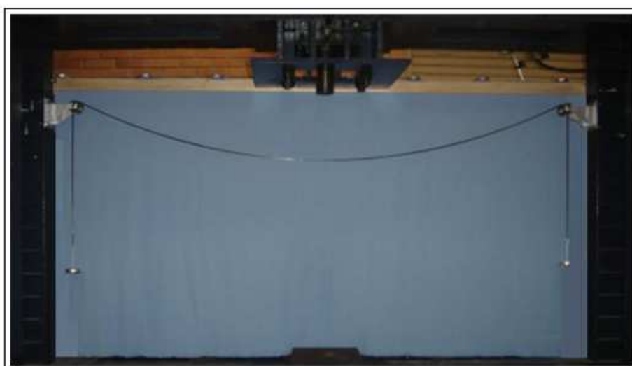
3. Sistema de un cable simétrico
