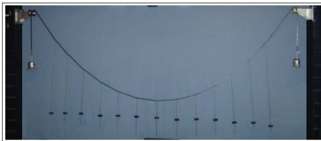
10. Sistema cable simétrico con carga distribuida.
