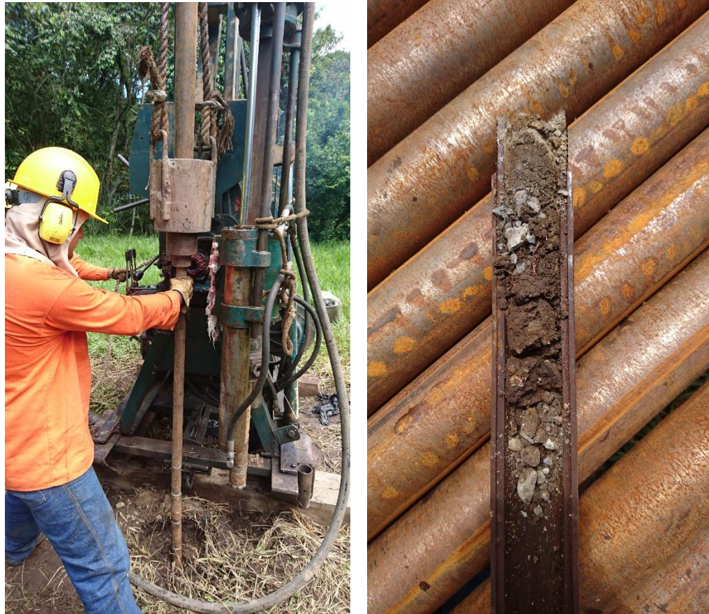
Figura 15. Ensayo de penetración estándar
