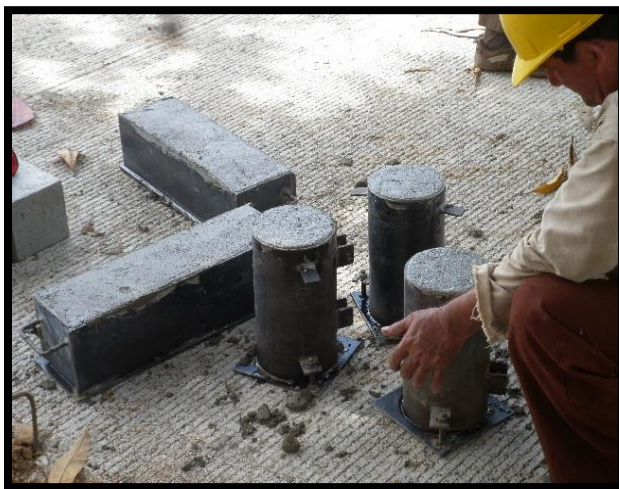
Fg9. Toma de cilindros y viguetas de concreto
