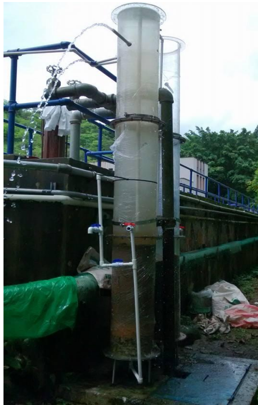
Figura 11. Montaje de las columnas de filtración
