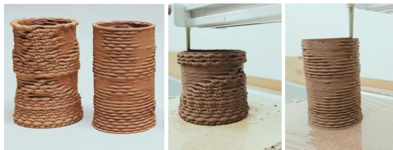
Figura 6. Modelos impresos en cerámica y su proceso de impresión. Autoría propia.
