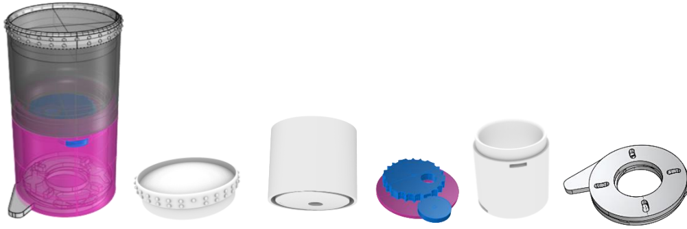
Figura 4. Propuesta de objeto dosificador de ingredientes sólidos y sus partes.
