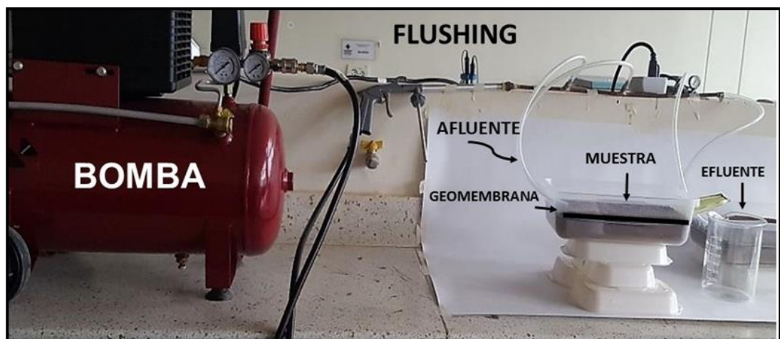
Figura 14. Vista frontal del proceso Flushing
