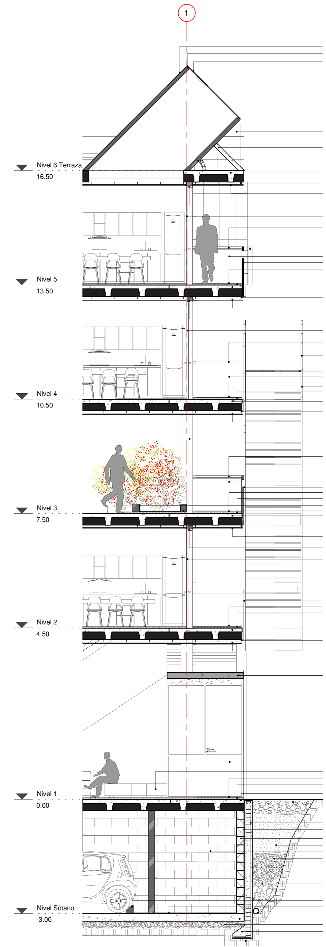
20 Corte por fachada Escala 1:50
