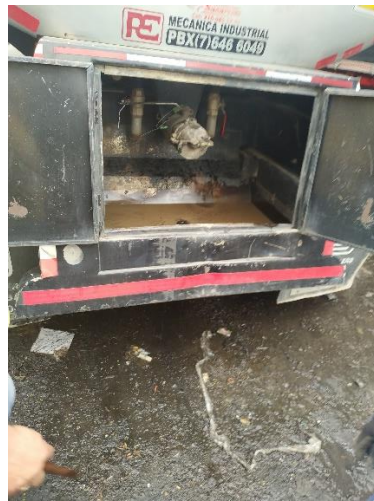
Figura 8. Inspeccion visual de valvula de desaguae de un tanque.
