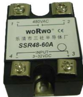
Figura 4.1 Apariencia real típica de un SSR 8
