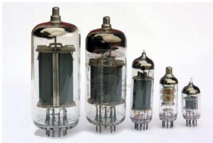
Figura 1.1 Apariencia física de un triodo de vacío
