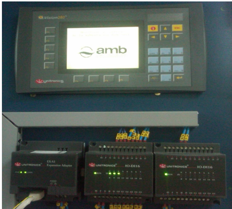
FIGURA 1: PLC MARCA: UNITRONICS MODELO: VISION 28
