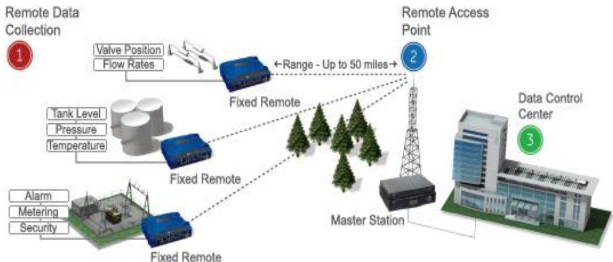
FIGURA 7: EJEMPLO DE APLICACIÓN DE LOS RADIOS UHF MDS SD4
