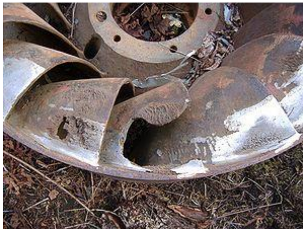
FIGURA 20: DAÑO POR CAVITACIÓN DE UNA TURBINA
