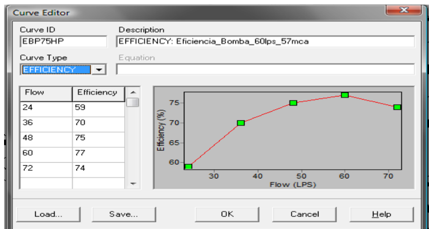
FIGURA 45: GRÁFICA EFICIENCIA Vs CAUDAL BOMBA 75 HP
