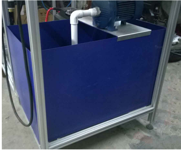
Figura 14. Tanque de acumulación.
