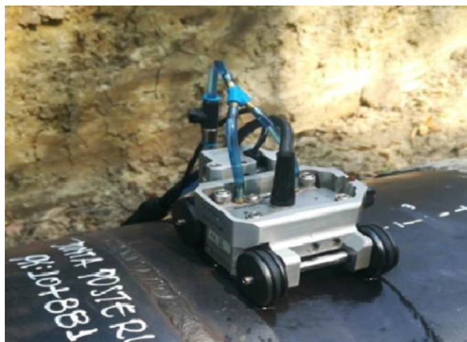
Ilustración 6. Tecnología que hace uso de emisión de ondas ultrasónicas. Fuente: Tomada de INSERCOR (2020).
