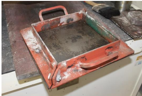
Figura 9. Limpieza y ajuste del Molde
