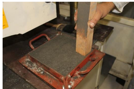
Figura 13. Apisonado de la mezcla
