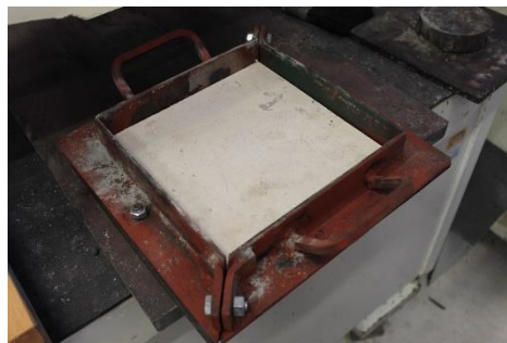
Figura 10. Molde con placa de asbesto-cemento
