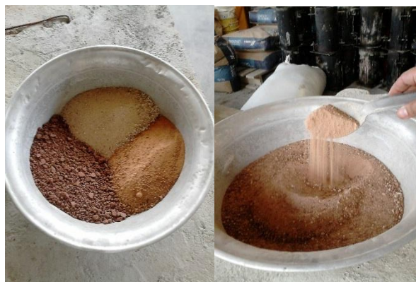
Figura 5. Tipos de agregado y mezcla de los mismos
