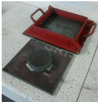
Figura 8. Molde construido (20x20 cm)
