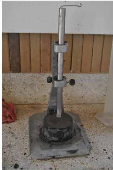
Figura 4. Penetración del aparato Vicat.
