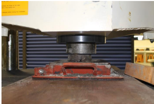
Figura 16. Ubicación del molde en la maquina universal
