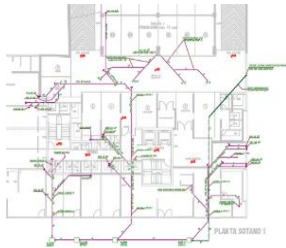
Figura 26. Trazado de colectores hacia las cajas de inspección de agua negra.
