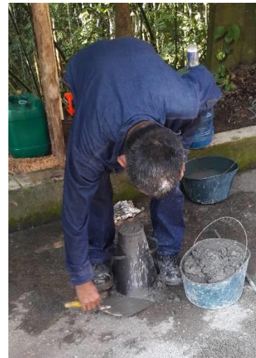
Ilustración 27 - Ensayo Cono Abrams
