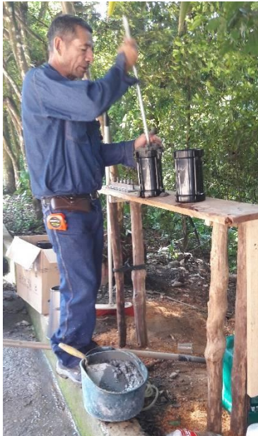
Ilustración 26 - Muestras de concreto 4000 psi
