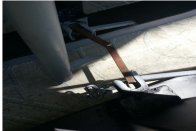
Anexo 2. Caída del péndulo a la probeta después del impacto
