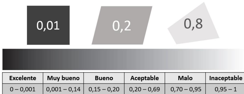
Figura 2.9 Métrica de mallado según la forma de la celda (oblicuidad)
