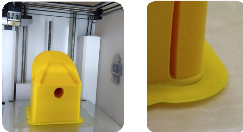
Ilustración 9 Primer cuerpo impreso - fenómeno de wrapping. Fuente: Autor
