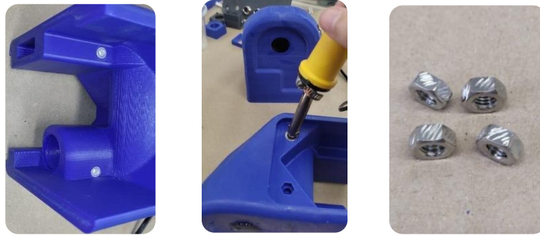
Figura 32 Integración de remaches y puntos de anclaje. Fuente: Autor
