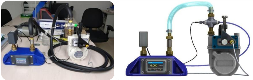
Figura 37 Montaje operativo Real V/s montaje CAD. Fuente: Autor
