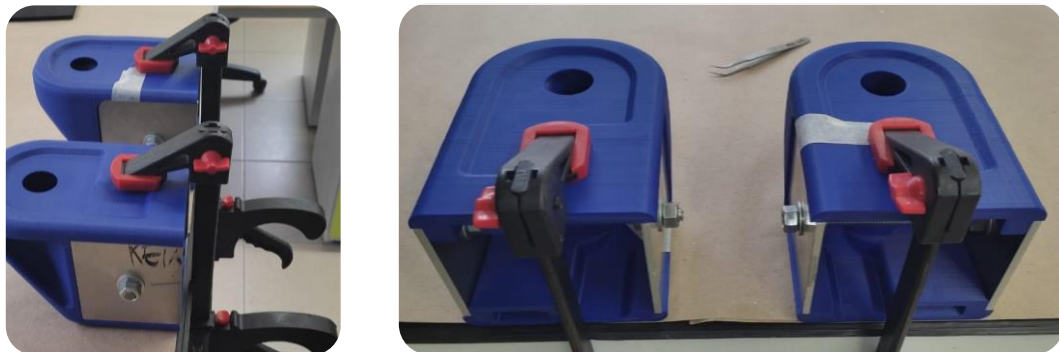
Figura 29 Preparación para verter capas de resina epoxica. Fuente: Autor
