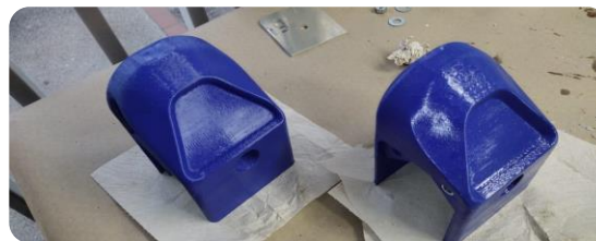
Figura 33 Acabado superficial en epóxico. Fuente: Autor
