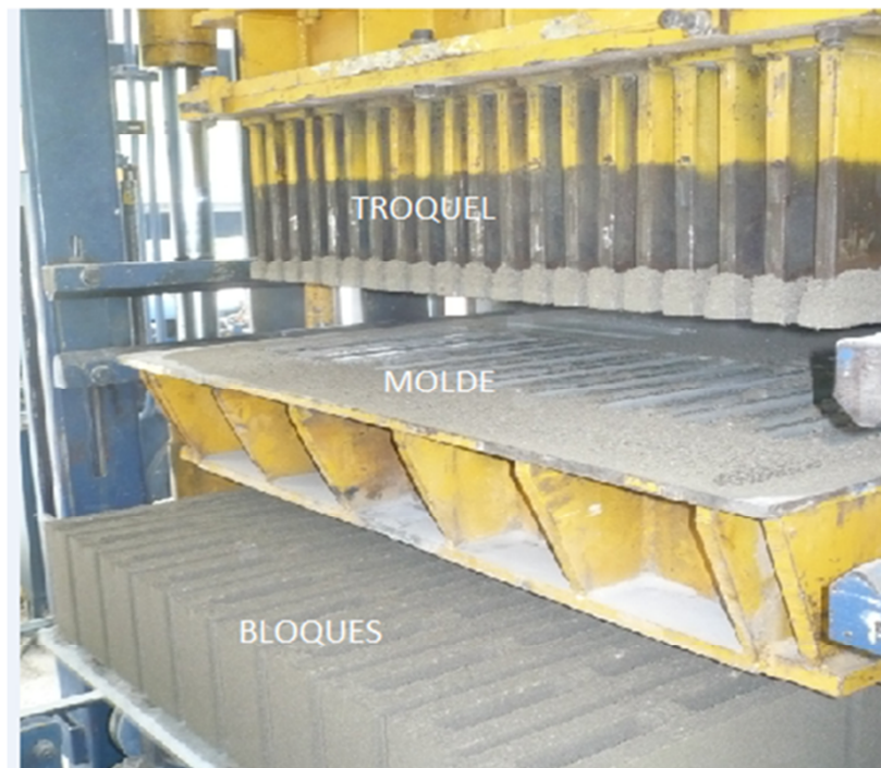
Figura 11. Molde y troquel para la elaboración del bloque.
