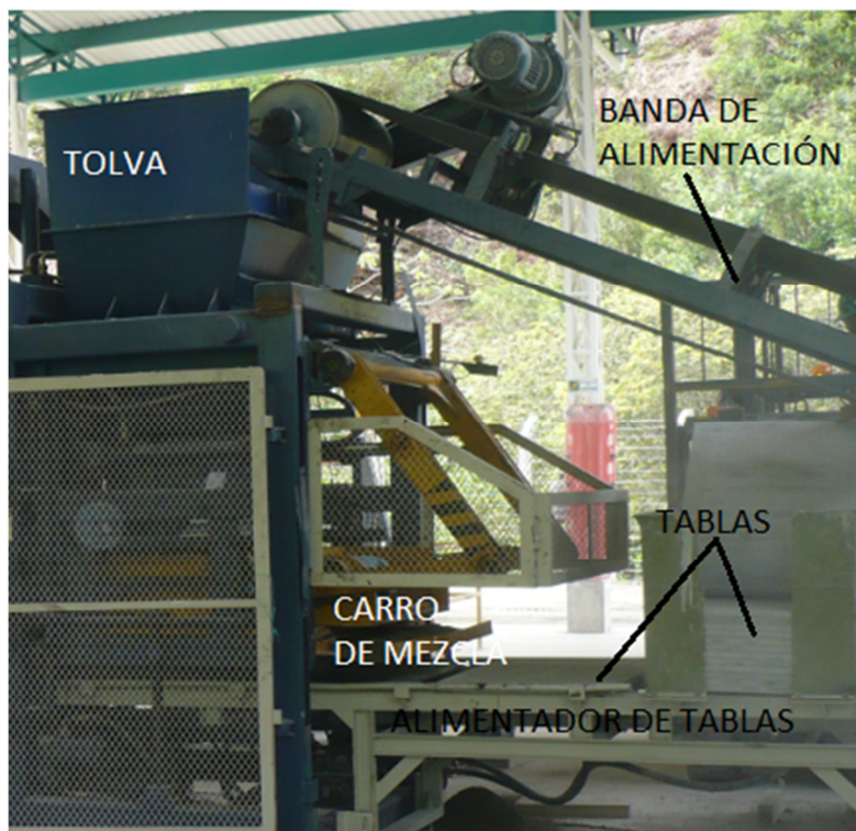
Figura 9. Partes de la máquina productora QFT 8-15 para la dosificación del cemento
