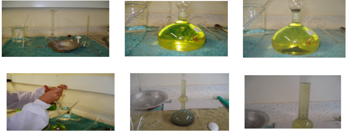
Figura 5. Ensayo de Peso específico del cemento.
