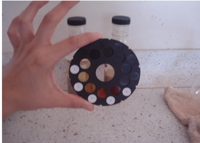
Figura 18. Demostración del grado de materia orgánica en la arena mediante la tabla de colores Gardner.
