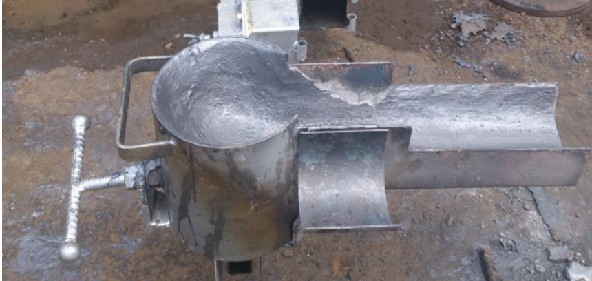
Figura 59. Vertedero construido para el sistema centrífugo
