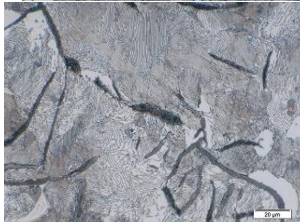
Fundicion gris con ataque 500X Matriz perlítica
