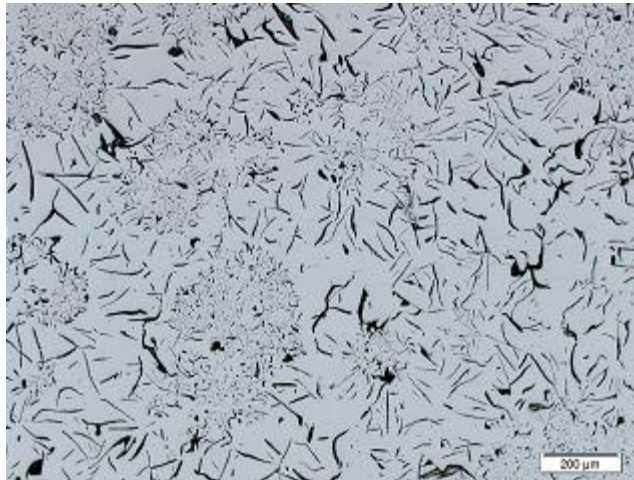
Fundicion gris sin ataque 100X tamaño #5 -tipo:B
