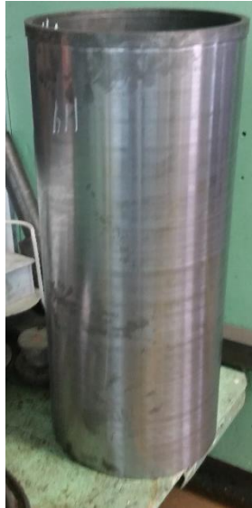
Figura 71. Acabo final de las camisas de hierro gris
