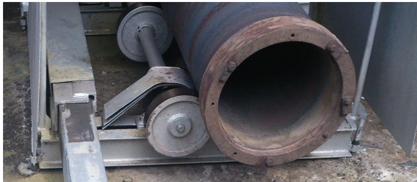
Figura 61. Sistema de Fundición Centrifuga con el molde de camisa de 15 Pulgadas
