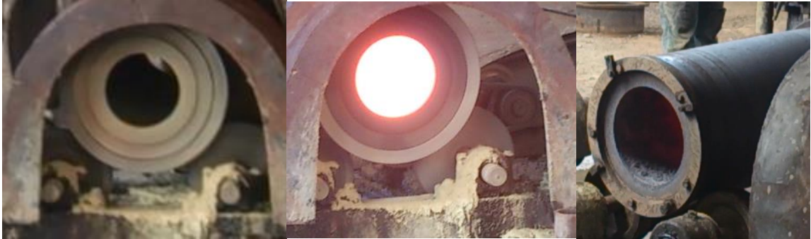
Figura 62. Molde de la camisa durante el proceso
