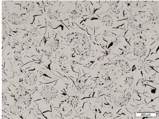
Fundicion gris sin ataque 100X tamaño#4 -tipo B
