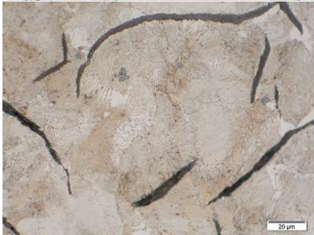
Fundicion gris con ataque ataque
