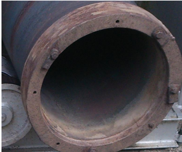
Figura 37. Molde de fundición para camisa
