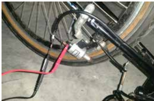
Imagen 4. Toma de datos por medio de multímetro.
