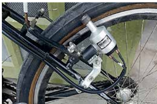
Imagen 1. Parte trasera de la bicicleta, Dinamo.
