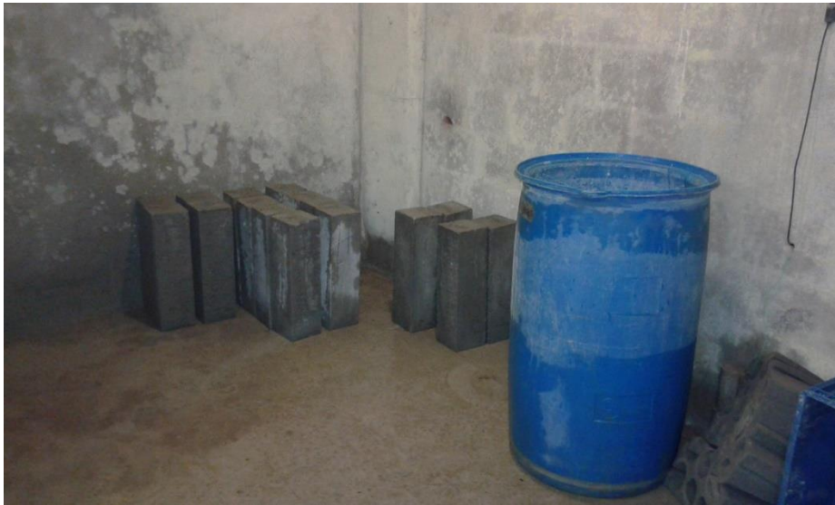
Cuarto de curado, espacio utilizado para viguetas – Fuente propia
