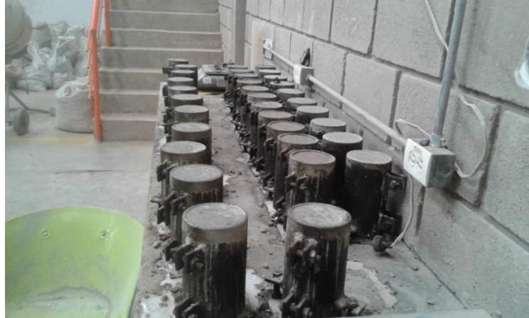
Mezcla realizada y encofrada – Fuente propia
