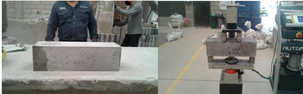
Vigüeta para ensayo – Fuente Propia
