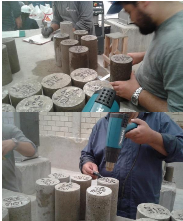
Medida de cilindros y secado con pistola de calor – Fuente propia
