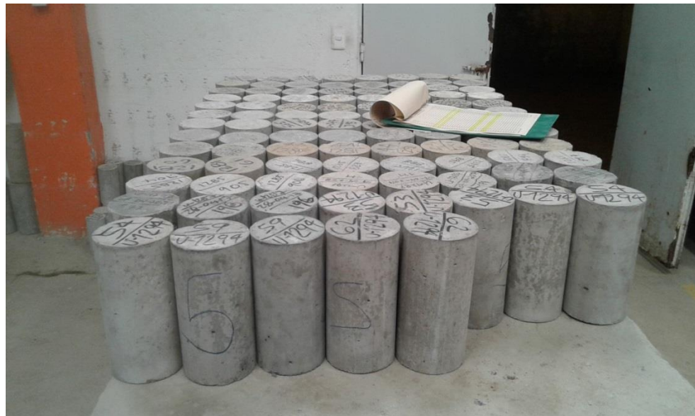
Organización cilindros a ensayar –Fuente propia
