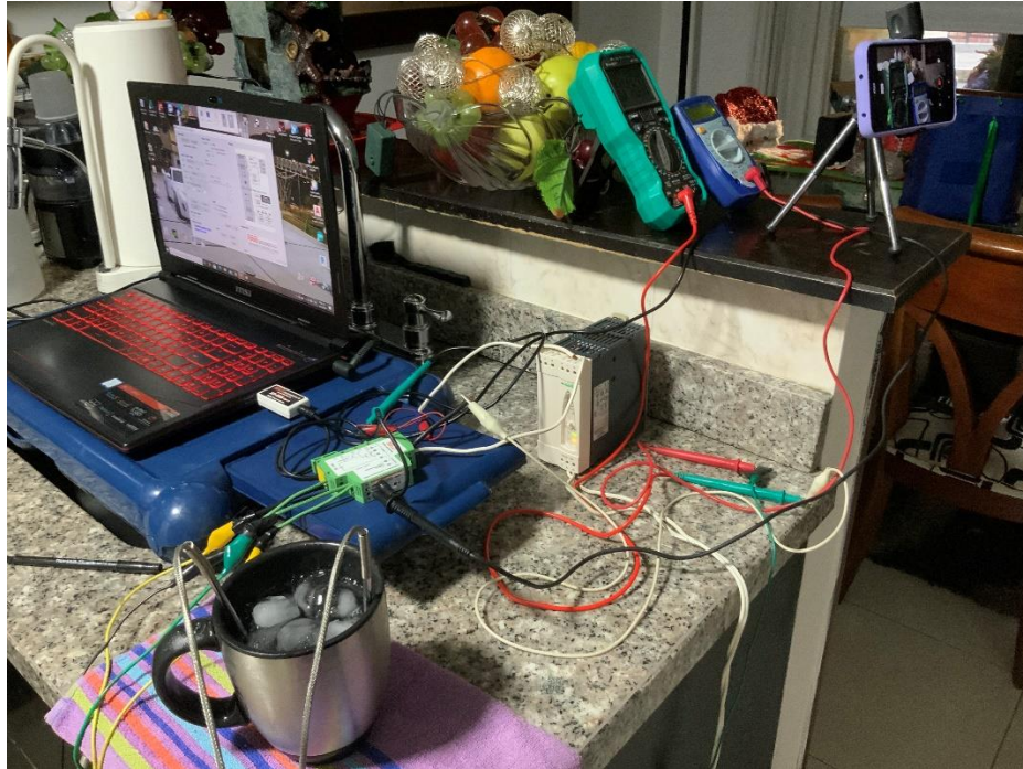
Prueba de operación a temperaturas de 0°C con transmisor XU2
