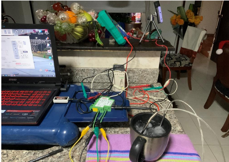
Figura 61. Montaje físico para pruebas de operación en transmisor modelo XU2. 64
