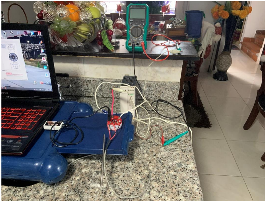
Montaje y pruebas de operación con transmisor XU2HN
