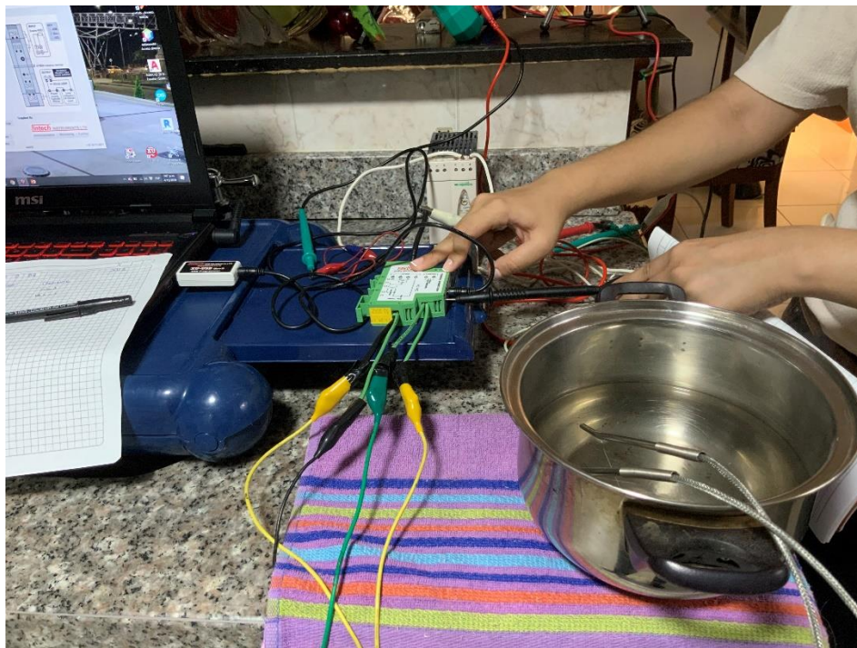
Prueba de operación a temperaturas de 85 °C con transmisor XU2
