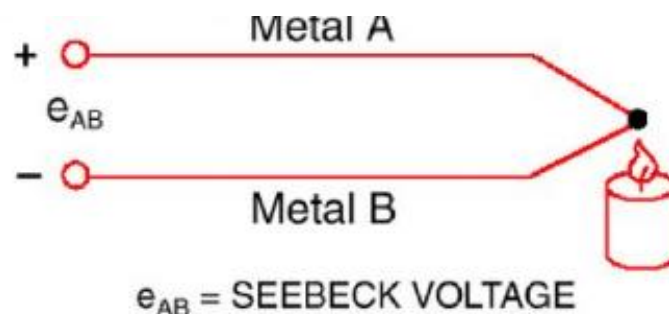
Figura 7. Funcionamiento de un termopar 7
