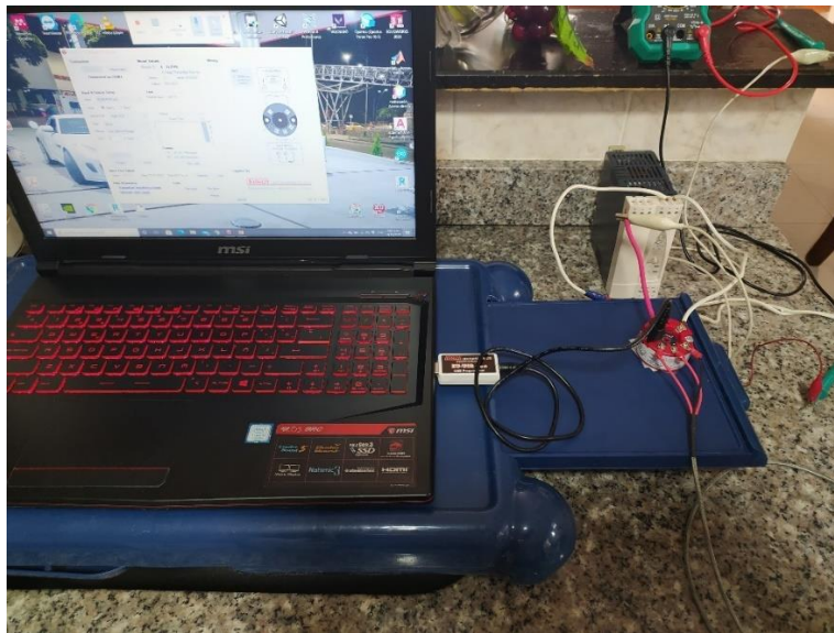
Figura 53. Montaje físico de lazo de corriente 4-20 mA en transmisor modelo XU2HN 53
