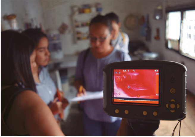
Figura 125. Medición de características arquitectónicas y de habitabilidad. Cámara termográfica modeladas en Irisys IR Series
