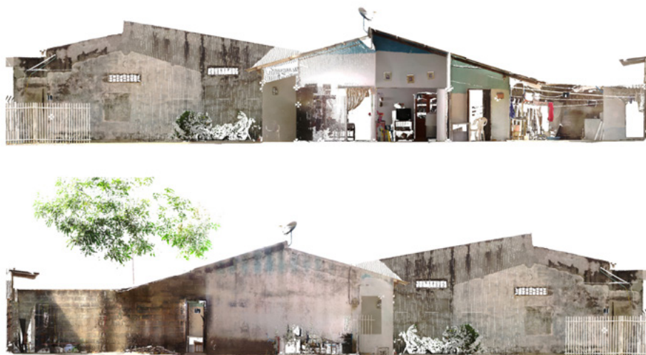
Figura 124. Medición de características arquitectónicas y de habitabilidad. Levantamiento arquitectónico con técnica laser escáner FARO Focus 3Dx130
