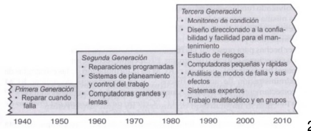
Figura 2.4: Cambios en las técnicas de mantenimiento. Fuente: MOUBRAY ALADON, John Y. Mantenimiento Centrado en Confiabilidad. 2. Ed. North Carolina
