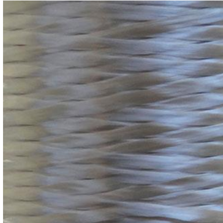
Ilustración 4. Roving directo PRFV [15]
