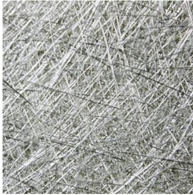
Ilustración 2. Fibra de vidrio MAT [12]
