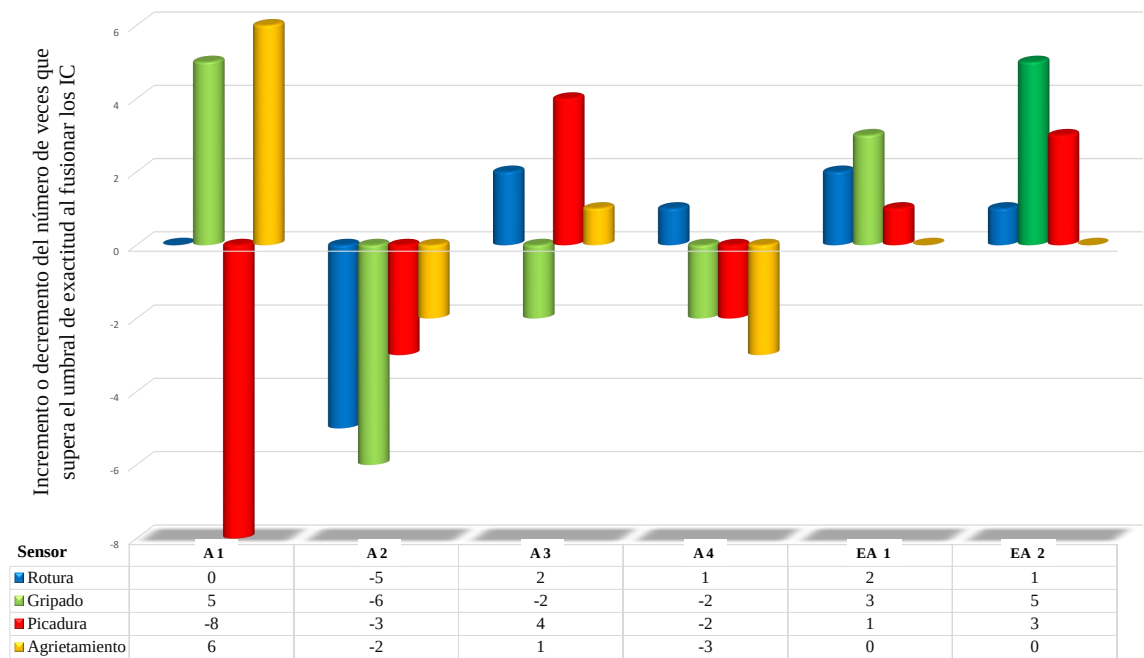
Figura 32: Variación del número de veces superan el umbral de exactitud, al fusionar los IC del dominio de tiempo y de la frecuencia de cada sensor para los diferentes fallos
