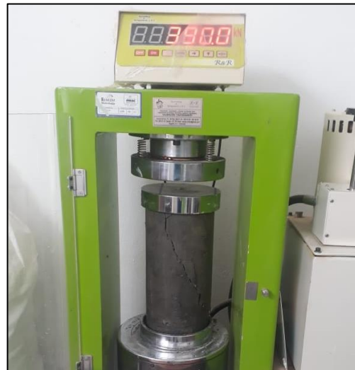
Fotografía 50. Se falla cilindro a los 28 días.
