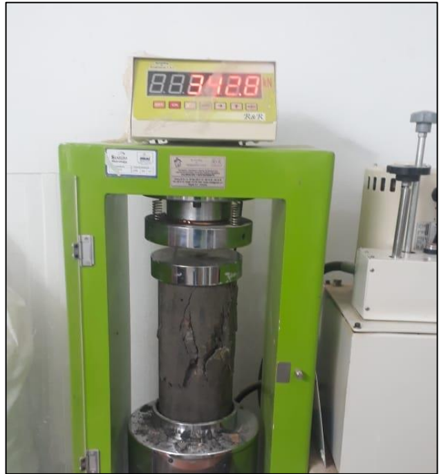
Fotografía 48. Se falla un cilindro a los 7 días.
