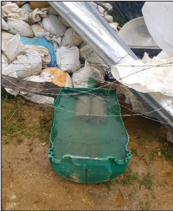
Fotografía 47. Se extraen cilindros de la formaleta y se introducen en agua.
