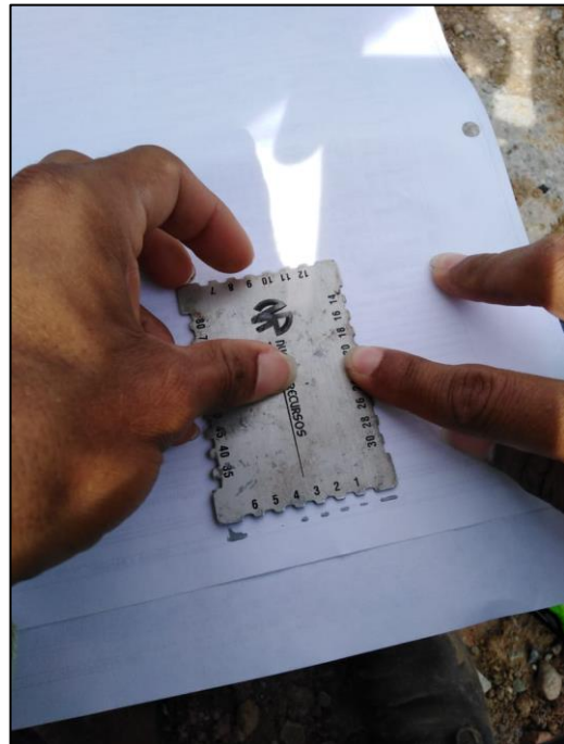
Fotografía 32. Medición del espesor de capa de pintura.
