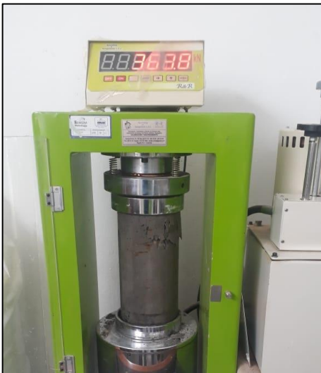
Fotografía 49. Se falla cilindro a los 14 días.
