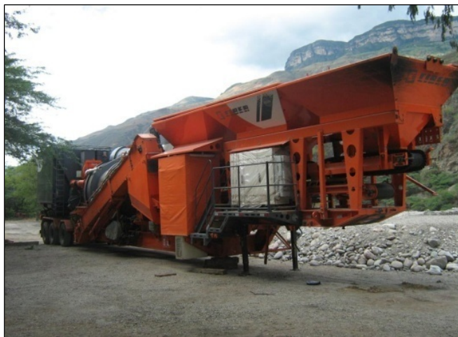
Figura 7. Planta de Asfalto Contraflujo.
