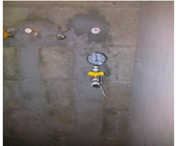
Figuras 85 y 86. Pruebas hidráulicas para sistema de tuberías hidráulicas.
