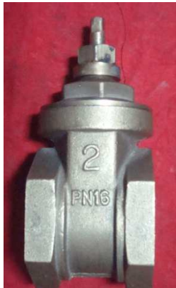
Foto 1. Válvula de compuerta. ALVAREZ, Pablo. Enero 2009
