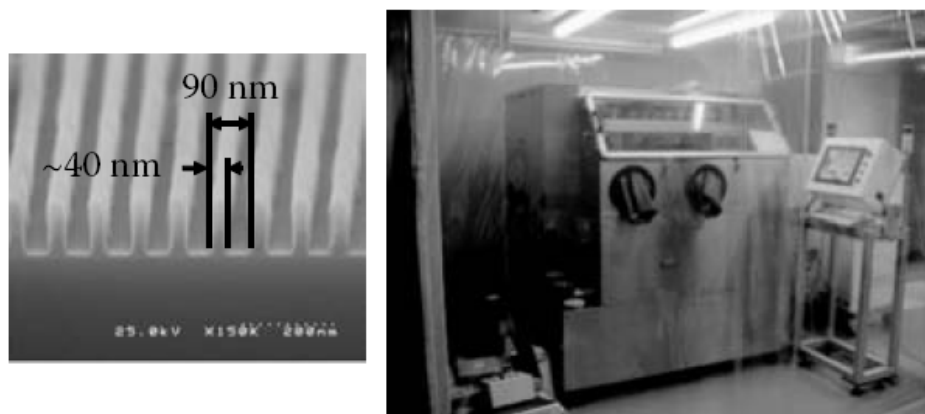
Figura 5.8. Litografía Nanofotónica. Derecha: Apariencia del sistema. Izquierda: Un escaneo con un microscopio de electrones de un patrón corrugado fabricado. Fuente: Principles of Nanophotonics .
