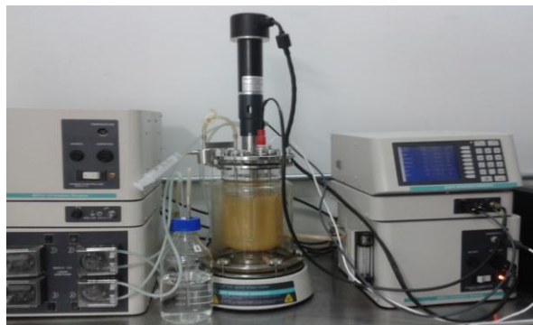
Figura 13. Montaje para la producción de nisina en reactor BioFlo 110.
