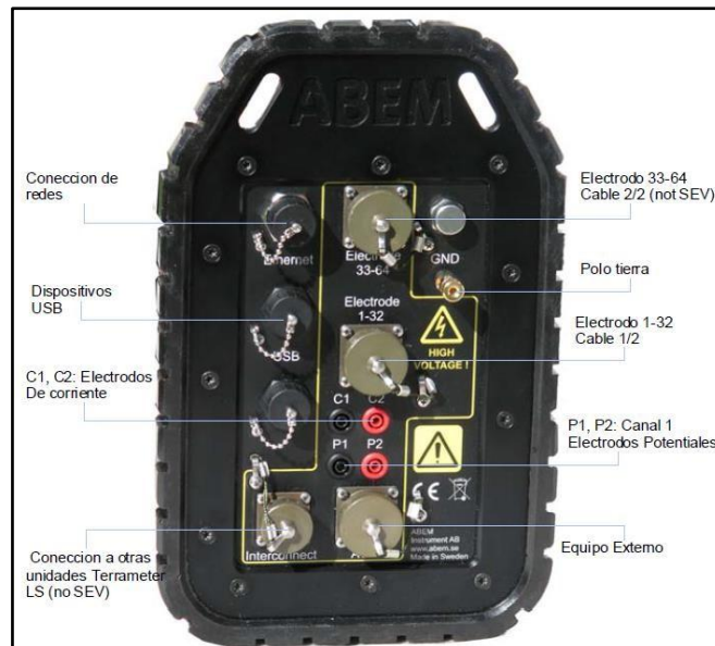
Figura No 8. Panel de conexiones del Terrameter LS. Fuente: Manual ABEM (en línea)
