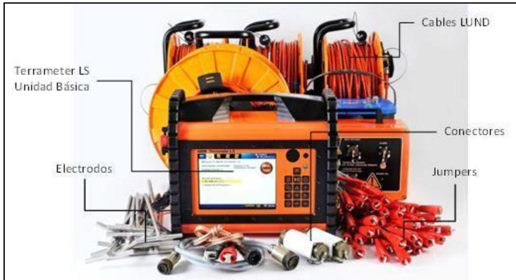
Figura No 7. Equipo utilizado para la medición de los datos de resistividad. Fuente: Manual ABEM (en línea).
