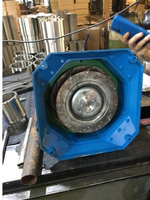
Figura 25. Ventilador de motor principal de CNC M059.
