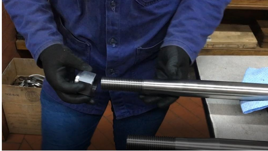
Figura 23. Prueba de roscas convencionales y de seguridad de tuercas a vástagos Gardner Denver.
