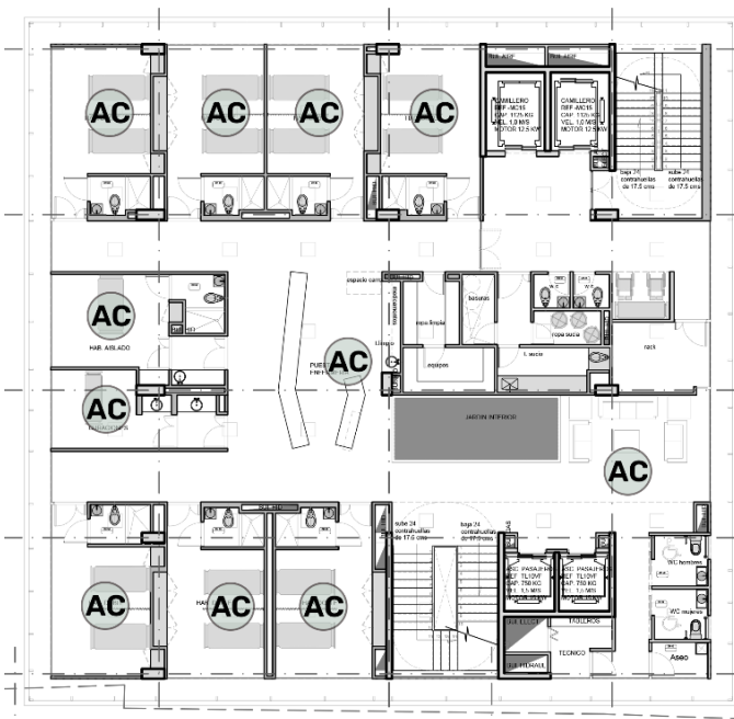
Figura 69. Planta piso 4 de la sala de hospitalización con instalación de aires acondicionados. Elaboración propia.
