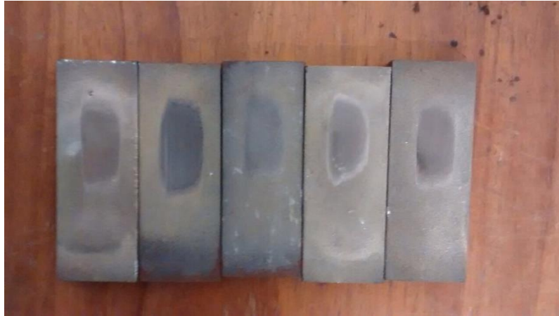
Fuente: autor de proyecto Figura 28: Probetas después de prueba de desgaste abrasivo.
