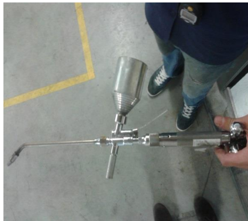
Fuente: Autor de proyecto Figura 13: Pistola de proyección térmica.
