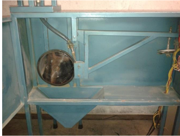
Figura 19: Interior máquina medidora de desgaste abrasivo. Fuente: Autor de proyecto
