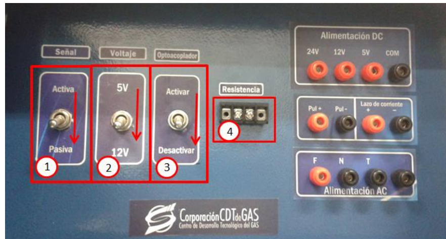
Figura 93. Conexión "Señal Pasiva" con 12V
