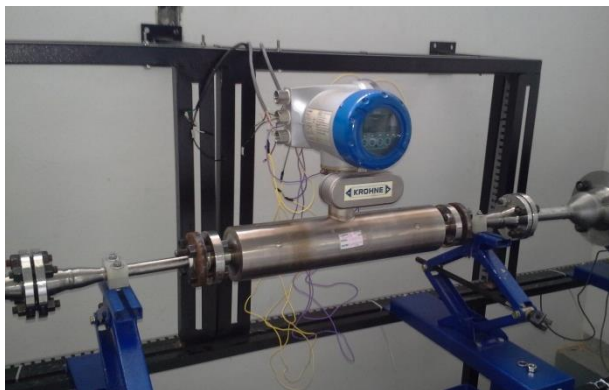
Figura 79. Conexión medidor a Opto 22
