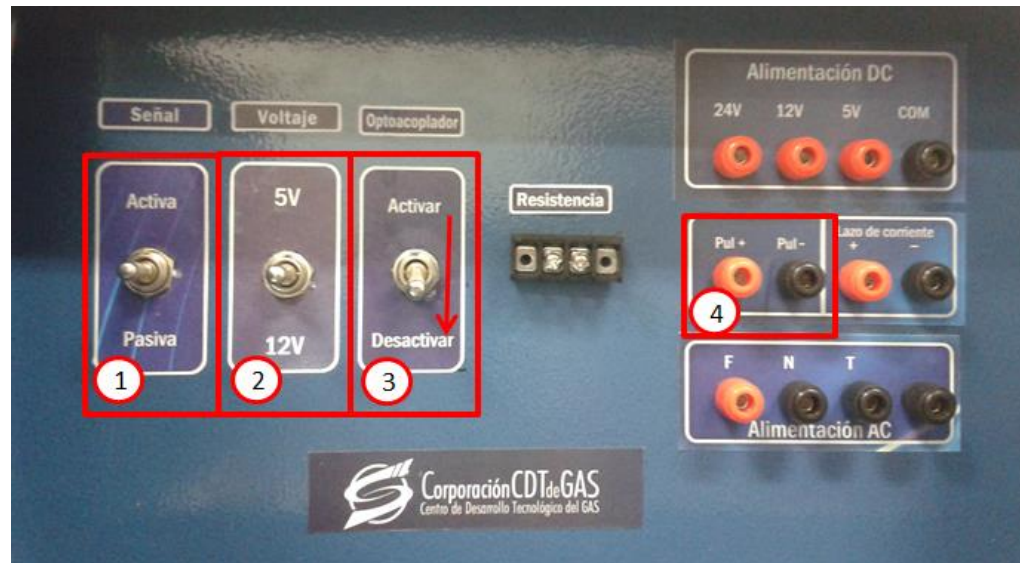
Figura 89. Conexión de Condiciones Iniciales
