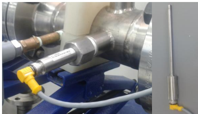
Figura 6. RTD del Banco Gravimétrico de Líquidos
