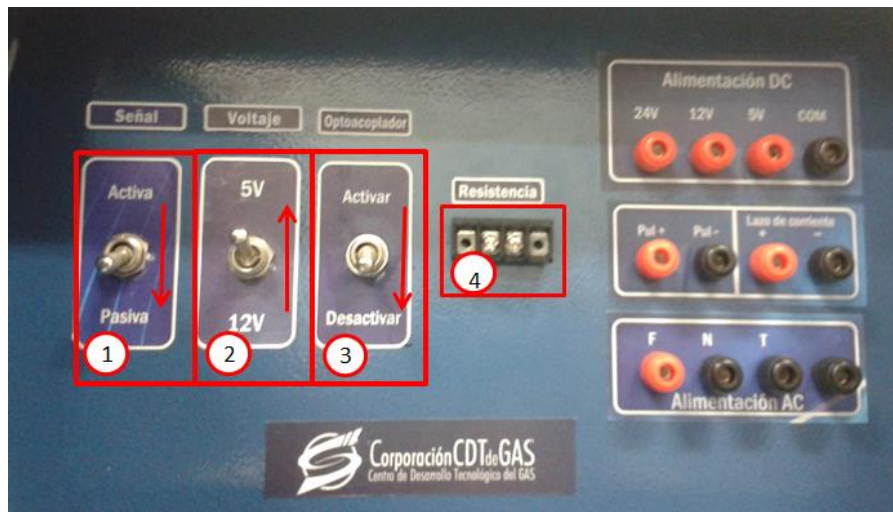
Figura 92. Conexión "Señal Pasiva" con 5V
