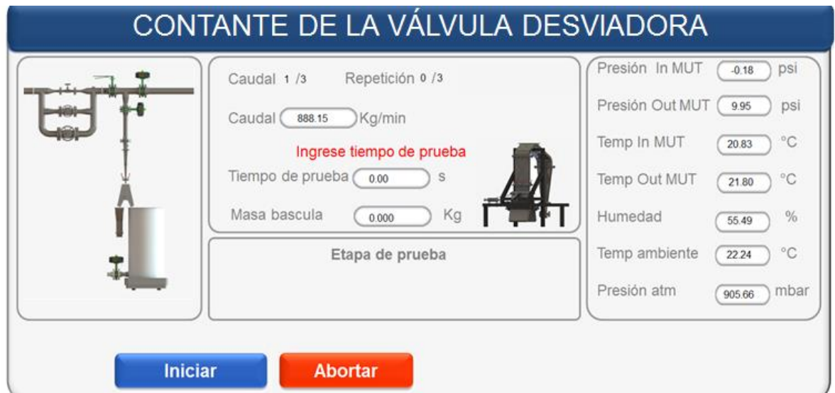
Figura 70. Constante de la válvula desviadora
