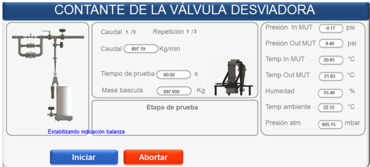
Figura 72. Estabilización de la indicación de la balanza
