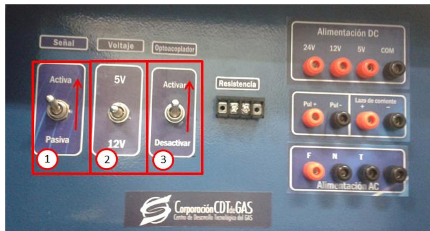
Figura 91. Conexión "Señal Activa" con Optoacoplador
