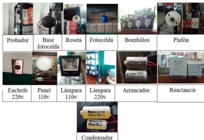
Figura 14. Implementos utilizados en el área de reparación de luminarias Fuente Autor
