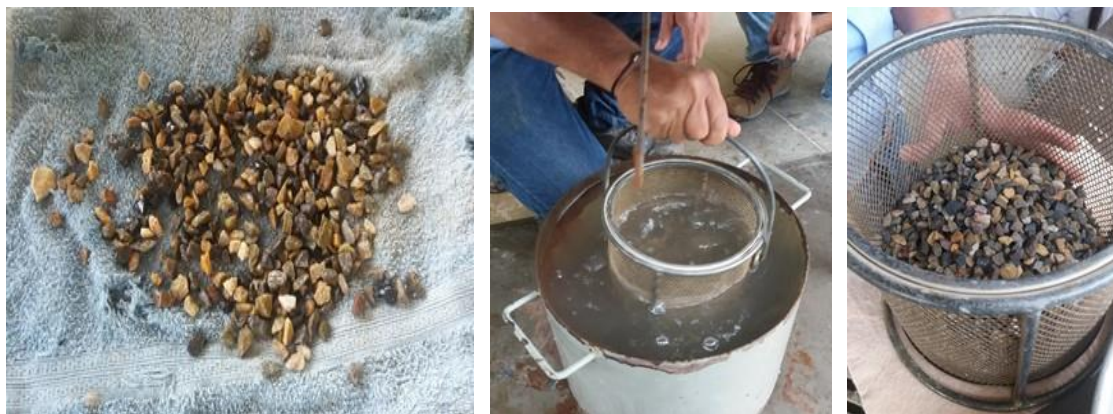
Figura 7. Ensayo de Laboratorio, Densidad Relativa y Absorción de los Agregados Gruesos.
