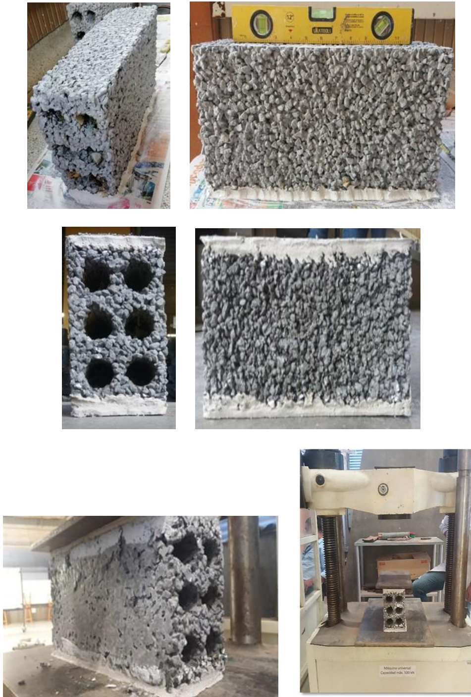
Figura 21. Ensayo de Laboratorio para la Resistencia a la Compresión de los BCP.
