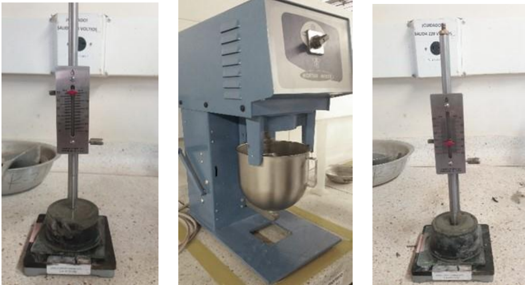
Figura 3. Ensayo de Laboratorio, Consistencia de la Pasta de Cemento.
