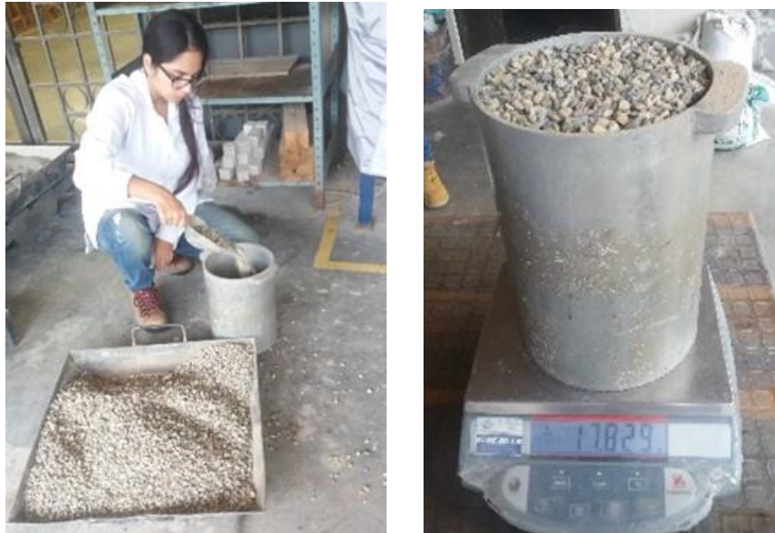
Figura 8. Ensayo de Laboratorio, Densidad Bulk.
