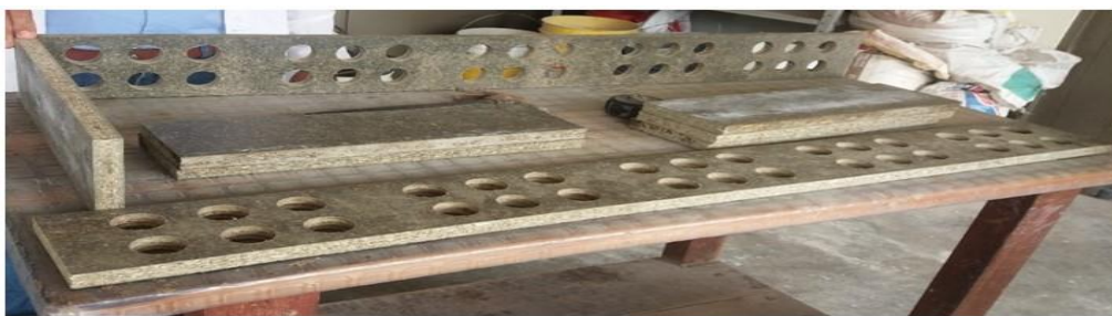
Figura 14. Formaletas para los Bloques.
