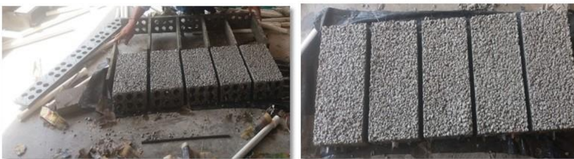
Figura 18. Desencofrado de los BCP.
