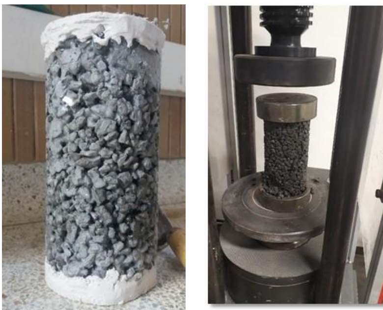
Figura 20. Ensayo de Laboratorio para la Resistencia a la Compresión de los Cilindros.
