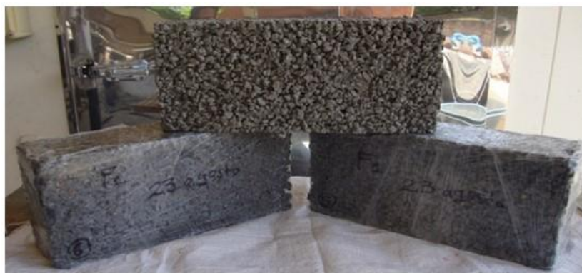
Figura 19. Desencofrado de los BCP.
