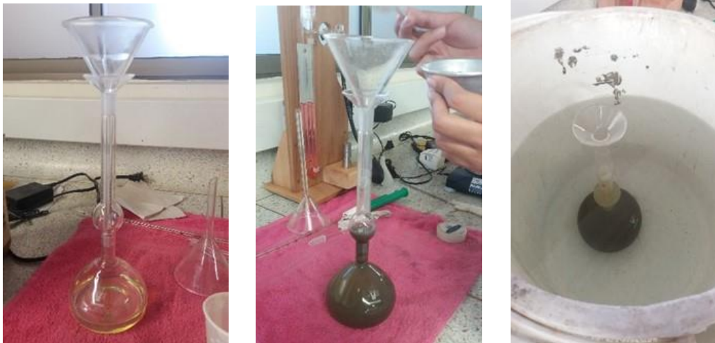
Figura 2. Ensayo de Laboratorio, Densidad del Cemento Hidráulico.
