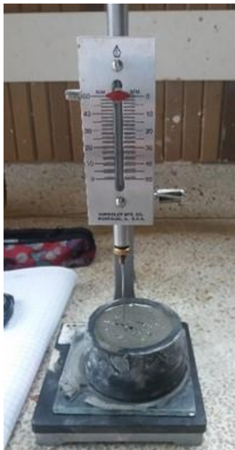
Figura 4. Ensayo de Laboratorio, Tiempo de Fraguado.
