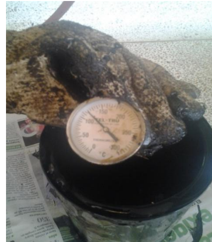
Foto 26. Temperatura ideal asfalto
