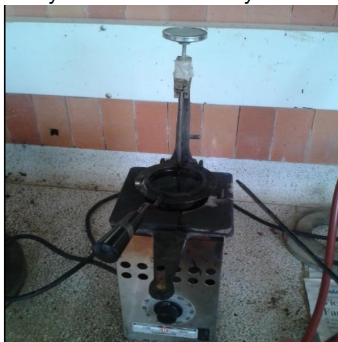
Foto 13. Ensayo de inflamacion y combustion
