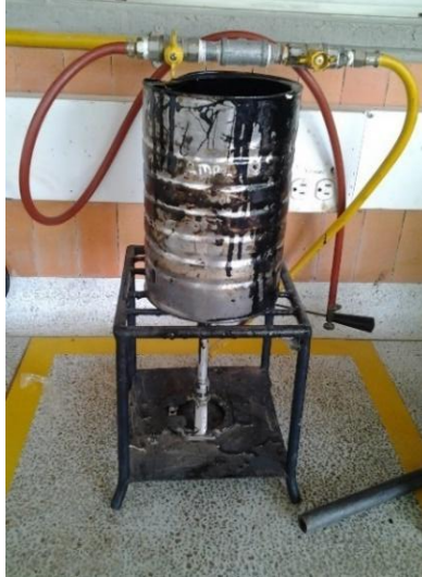
Foto 34. Calentamiento del asfalto.
