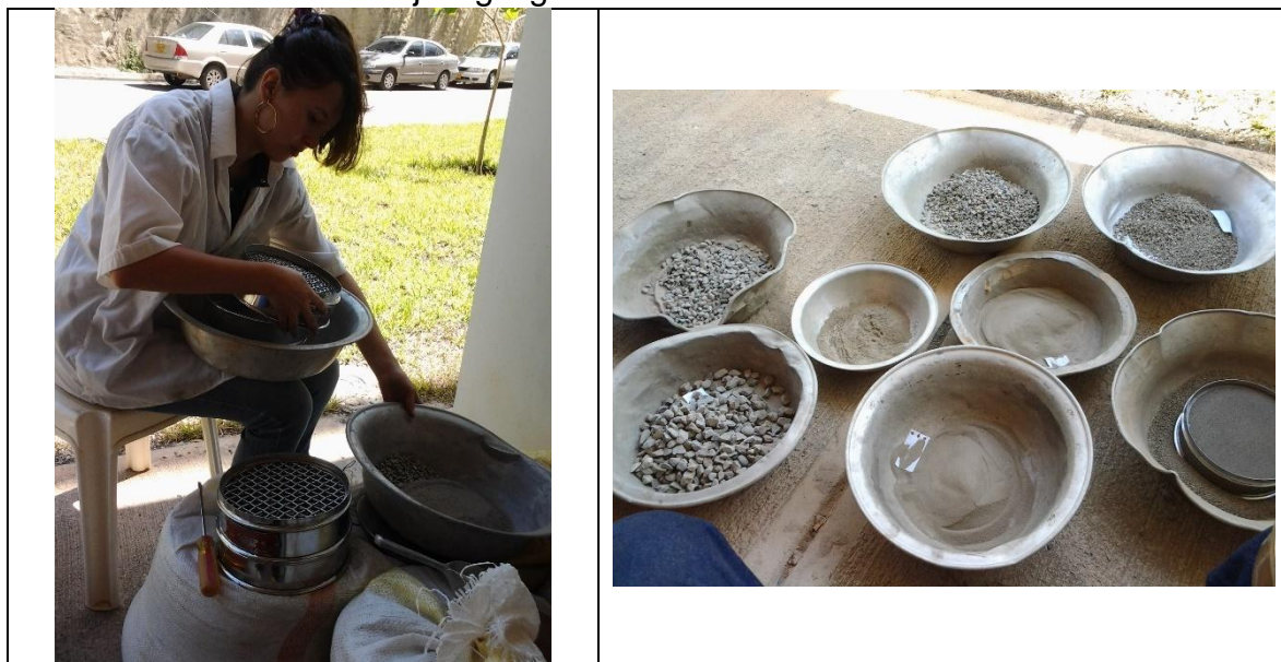
Foto 1. Tamizaje agregado a utilizar en la mezcla asfáltica
