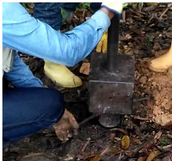
Figura 27. Desenroscado del martinete.
