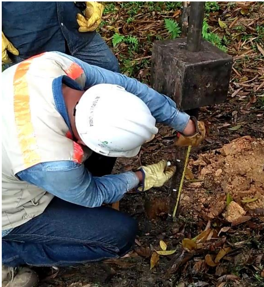
Figura 26. Se marcan otras 18 pulgadas cada 6 pulgadas.
