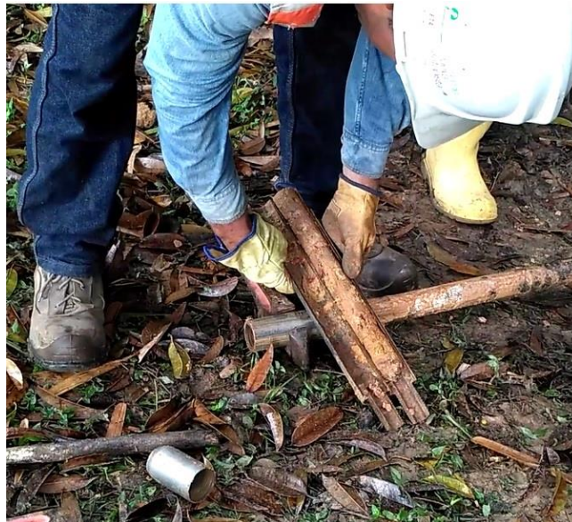
Figura 31. Abertura de la cuchara partida (Split Spoon - SS).
