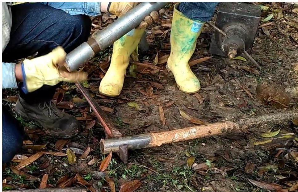
Figura 30. Desenroscado de la punta del muestreador.
