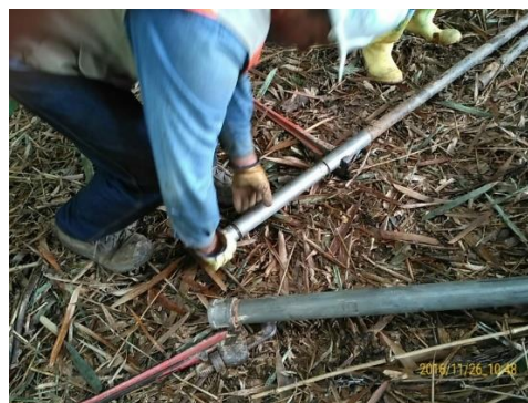
Figura 16. Unión punta, muestreador y primera tubería de perforación.
