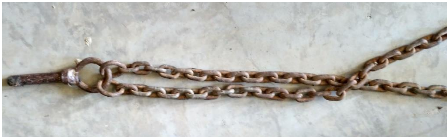
Figura 11. Perno y cadena del sistema de caída.
