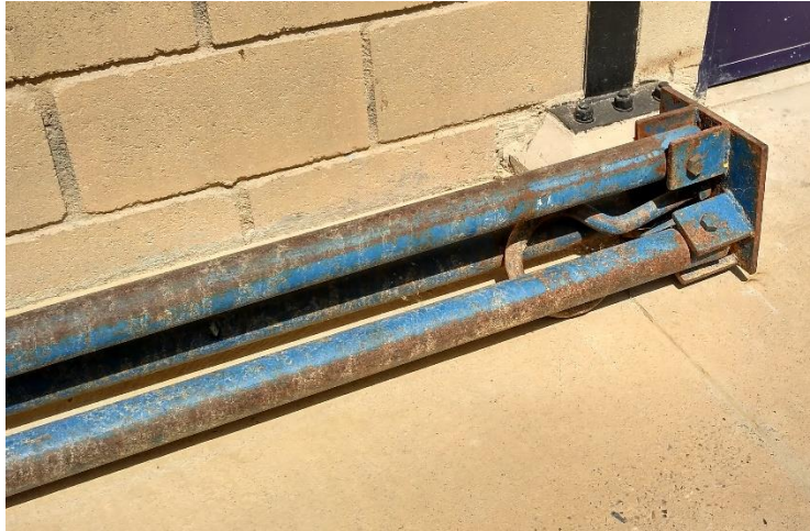
Figura 10. Trípode del sistema de caída.
