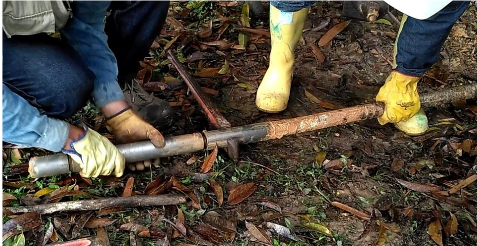
Figura 29. Desenroscado del muestreador de la tubería de perforación.
