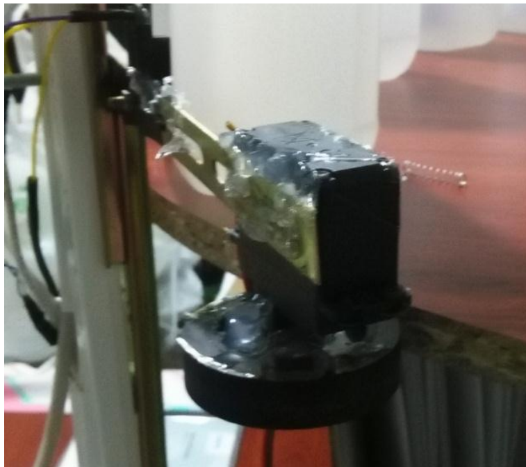
Figura 1. Motor DC para movimiento de la bandeja giratoria. Fuente el Autor.
