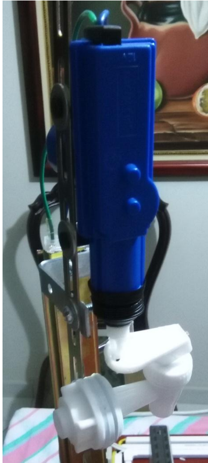
Figura 4. Actuador lineal eléctrico acoplado a válvula. Fuente Autor
