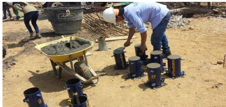
Fig. 87 Cilindros de cooncreto. Fuente Propia.
