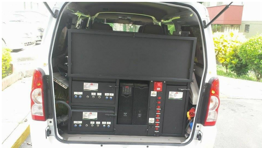
Fotografía 10. Equipos de medición de gases ensamblados a camioneta para control y seguimiento a las fuentes móviles.
