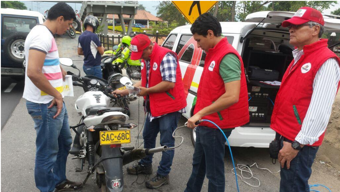
Fotografía 12. Toma de muestra de gases a motocicleta cuatro tiempos.
