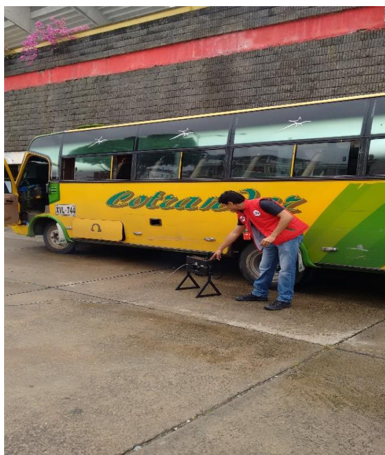
Fotografía 11. Toma de muestra de gases a bus público para análisis de opacidad.
