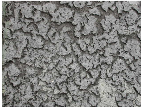
Imagen 5. Aspecto de la costra de los Filtros de Turba
